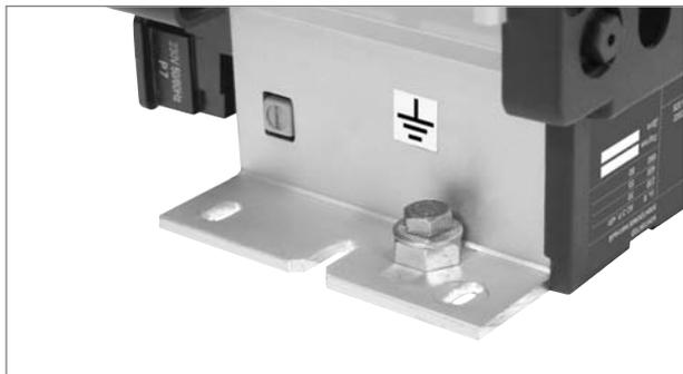
Основание выполнено из специального алюминиевого профиля, который является несущей конструкцией для блока контактов, магнитной системы и катушки управления. На внешней стороне основания предусмотрен болт для подключения заземления. Это соответствует требованиям ПУЭ.
