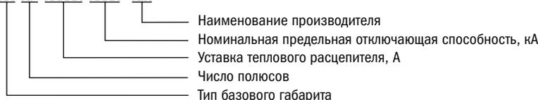
Пример обозначения выключателя при заказе и в документации другого изделия: выключатель автоматический в исполнении 3З габарита трёхполюсный на номинальный ток 125 А с номинальной предельной отключающей способностью 35 кА торговой марки IEK® – ВА88-33 3Р 125А 35кА ИЭК.
