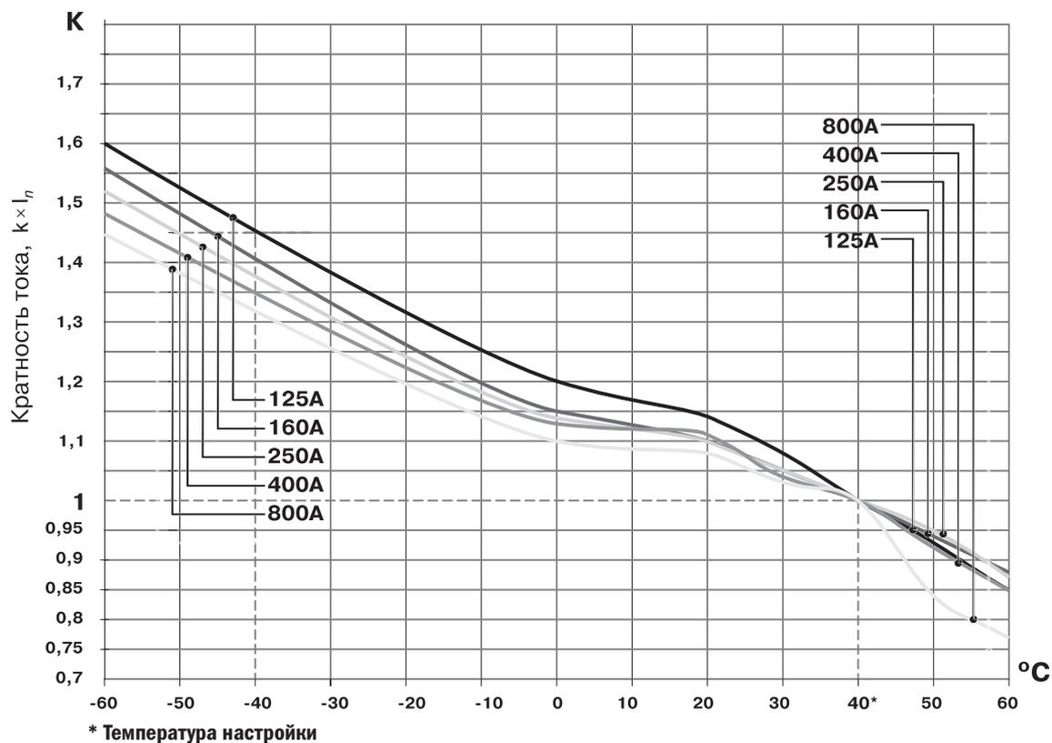
Характеристика токоограничения выключателей при напряжении 400 В
