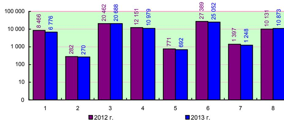
1 – Поджоги; 2 – Неисправность производственного оборудования; 3 – НПУиЭ электрооборудования; 4 – НПУиЭ печей; 5 – Нарушение ППБ при проведении огневых и сварочных работ; 6 – Неосторожное обращение с огнем; 7 – Шалость детей с огнем; 8 – Прочие причины
