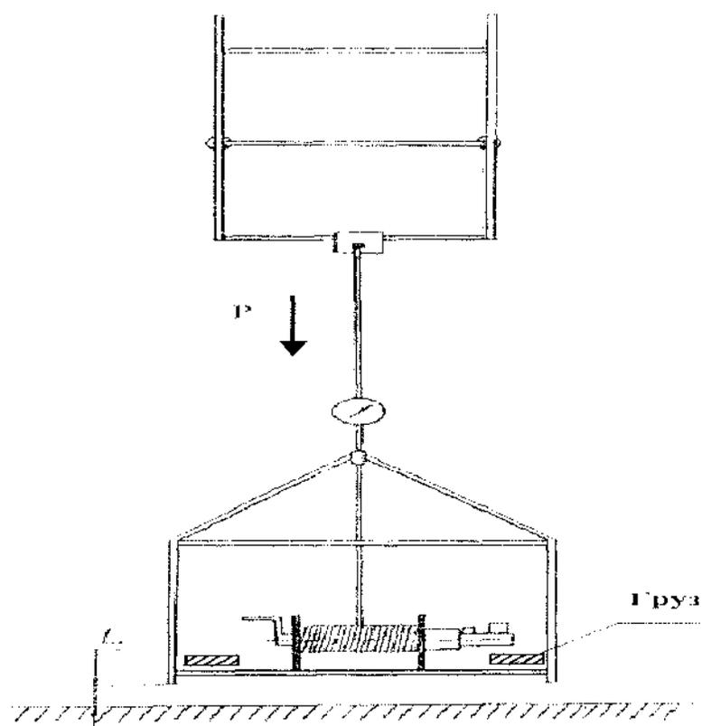
Рис. 6.1. Испытание на прочность ступени лестницы (высота отрыва площадки от земли  $L = 100-200$  мм)
