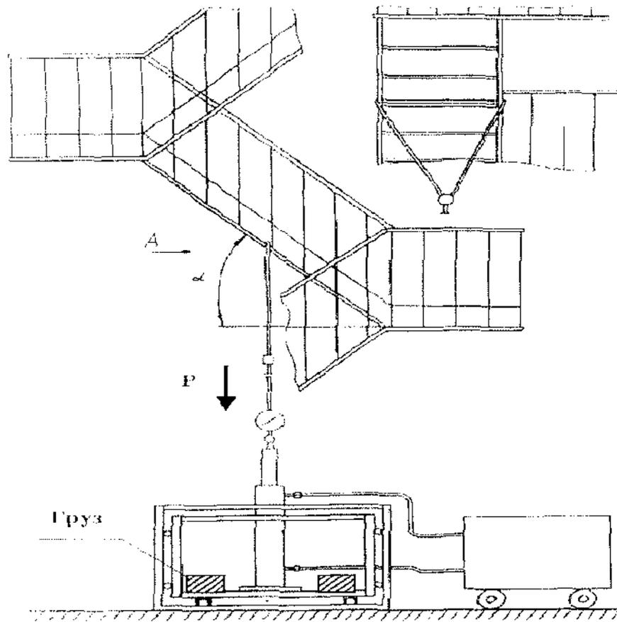
Рис. 6.3. Испытание на прочность марша лестницы
