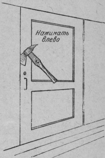
Рис. 6. Открывание двери топором.
