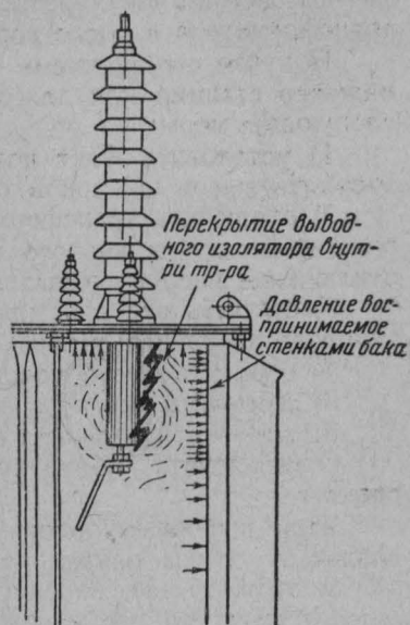
Фиг. 32б. Пожар в трансформаторе при перекрытии выводного изолятора.
