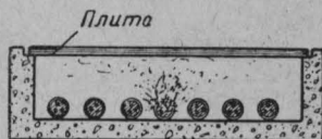
Фиг. 36. Прокладка кабеля в канале.
