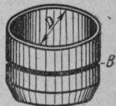
Фиг. 10. Приспособление для отбора пробы для определения плотности угля в штабеле.
