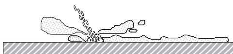
Рис. 2. Расширение CO 2 и кинетическая энергия гранул сбивают и удаляют частицы снимаемого покрытия
