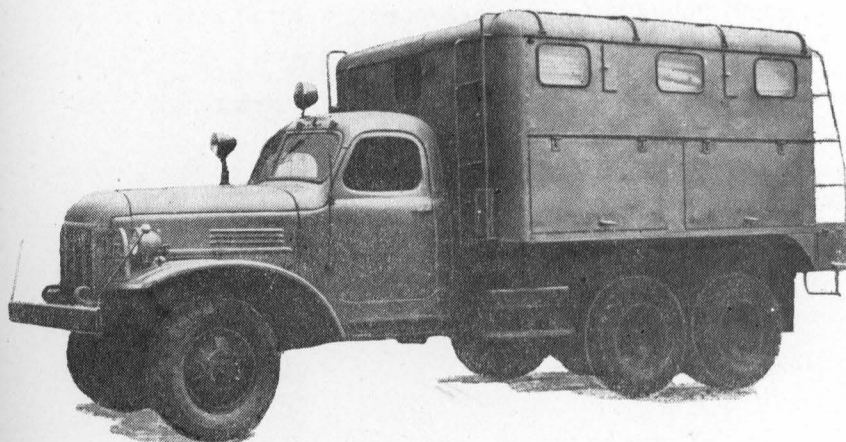
Рис. 50. Рукавный пожарный автомобиль АРП-2,5 (157).
