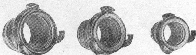
Рис. 119. Головки соединительные рукавные.
