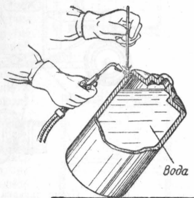
Фиг. 85. Правильное положение сосуда из-под горючих жидкостей, заполненного водой при заварке.
