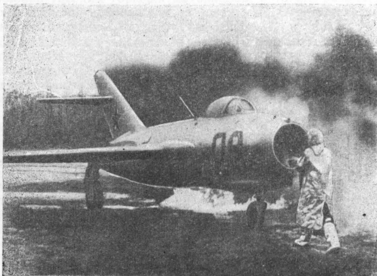
Рис. 107. Тушение пожара в самолете переносной огнегасительной установкой СЖБ-50
