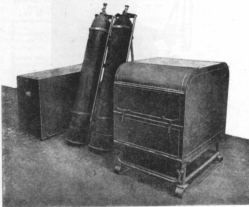
Рис. 102. Полевая зарядная углекислотная станция ПЗУС в комплекте (весы, стойка с баллонами, станция)
