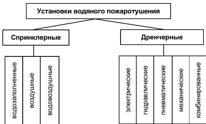
Рис. 1.8. Классификация установок водяного пожаротушения
