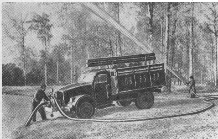
Рис. 51. Мотопомпа лесная — зарядный агрегат МЛАЗ-100
