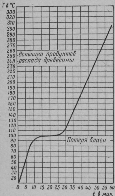
Рис. 14. Ход кривой показывает температуру T прилегающей к штукатурке (толщиной 2,5 см) поверхности древесины при температуре поверхности штукатурки 800\text{--}860^{\circ}\text{C}
