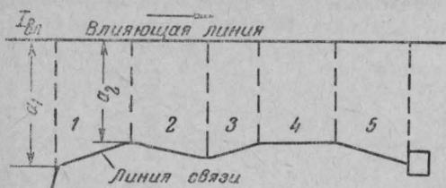
Рис. 41. Сложная трасса сближения линии связи с влияющей линией
