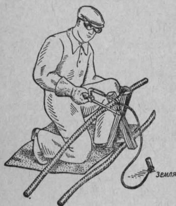
Рис. 65. Резка кабеля
