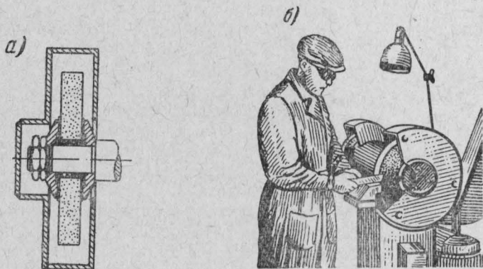
Рис. 77. Крепление и ограждение абразивного круга: а) крепление круга на шпинделе станка, б) общий вид
