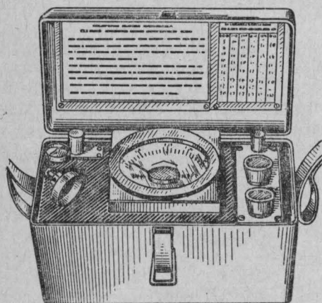
Рис. 67. Общий вид и схема газоанализатора ПГФ:
