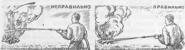
Рис. 11. Куда нужно направлять струю воды из ствола при тушении огня.
