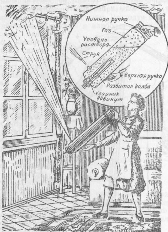
Рис. 7. Как надо держать огнетушитель при тушении огня на потолке и верхней части стены.
