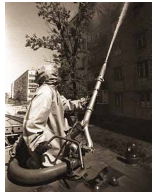
Реактивная установка для тушения пожаров – изготовлена в Германии на базе советского танка с двигателем МИГ, для ликвидации последствий аварии на Чернобыльской АЭС. Экспонат музея пожарной охраны г. Фулда (Германия) Fire extinguishing jet plant – Was produced in Germany on the base of Soviet tank with MIG engine for accident consequences liquidation on Chernobyl atomic power plant. The exhibit of fire prevention museum in Fulda (Germany)
