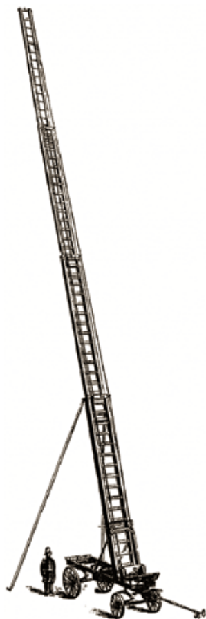
МЕХАНИЧЕСКАЯ ЛЕСТНИЦА, выдвинутая во всю свою высоту (12 саж.). Впервые была построена в С.-Петербургском пожарном депо в 1885 г. MECHANICAL STAIRS pulled out in a whole height (12 sazhen) For the first time it was built in Saint-Petersburg Fire station in 1885
