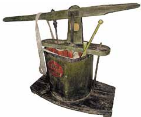
РУЧНОЙ ПОЖАРНЫЙ НАСОС для охраны от пожара бота «Фортуна». 1852 г. MANUAL FIRE PUMP for boat "Fortuna" fire guard. 1852
