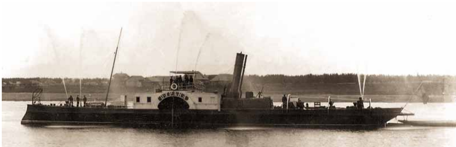
Пожарный колесный пароход Рыбинской речной полиции «Охрана» (Номин. число сил-120 л.с., индик.- 400 л.с., длина 150 футов, ширина-24 фута). Начало XX в. Rybinsk water police fire paddleboat "Guards" (Powers nominal number is 120 staff personnel, meter is 400 liters a second, a length is 150 feet, a width is 24 feet). The beginning of the XX century
