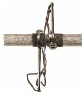
СОЕДИНЕНИЕ ПОЖАРНЫХ РУКАВОВ МЕЖДУ СОБОЙ. 1890 г. Junction of fire hoses. 1890
