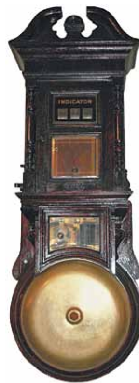
ИНДИКАТОР СИСТЕМЫ «ГЕМВЕЛЬ» Звонок электрической пожарной сигнализации, оповещающий о пожаре пожарные команды и указывающий место подачи сигнала "GEMVEL" SYSTEM INDICATOR
