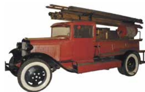
АВТОНАСОС ГАЗ-АА Двухосный автомобиль, снабженный центробежным насосом и пожарным оборудованием. Горьковский завод. 1932 г. АВТОПУМР GAS-AA A biaxial car, equipped by centrifugal pump and fire equipment. Gorkov factory. 1932
