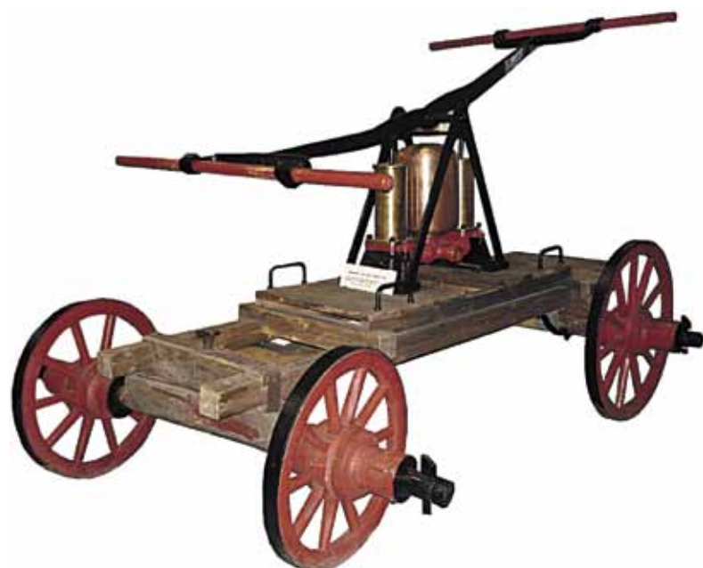
Пожарный конный ход с ручным насосом московской фирмы «Густав Лист» выпуска до 1907 г. Fire horse-drawn machinery with hand pump of Moscow firm "Gustav List", production before 1907
