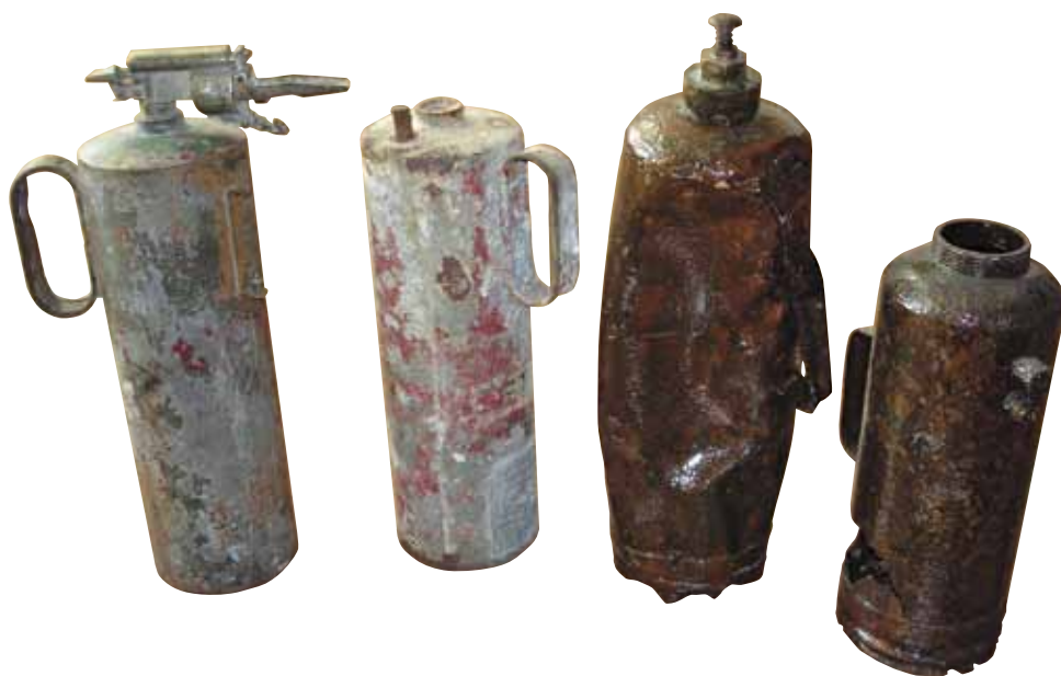
ОГНЕТУШИТЕЛИ ИЗ ТАНКОВ. Период Великой Отечественной войны FIRE EXTINGUISHERS FROM TANKS. The Great Patriotic War period
