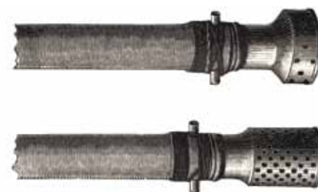
МЕТАЛЛИЧЕСКАЯ РЕШЕТКА, посредством которой забирной рукав втягивает в себя воду из водовместилща. 1890 г.
