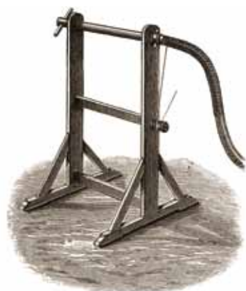
СТАНОК ДЛЯ НАВЯЗКИ РУКАВА с соединительной гайкой. 1890 г. A LATHE FOR HOSE FASTENING with connecting screw. 1890
