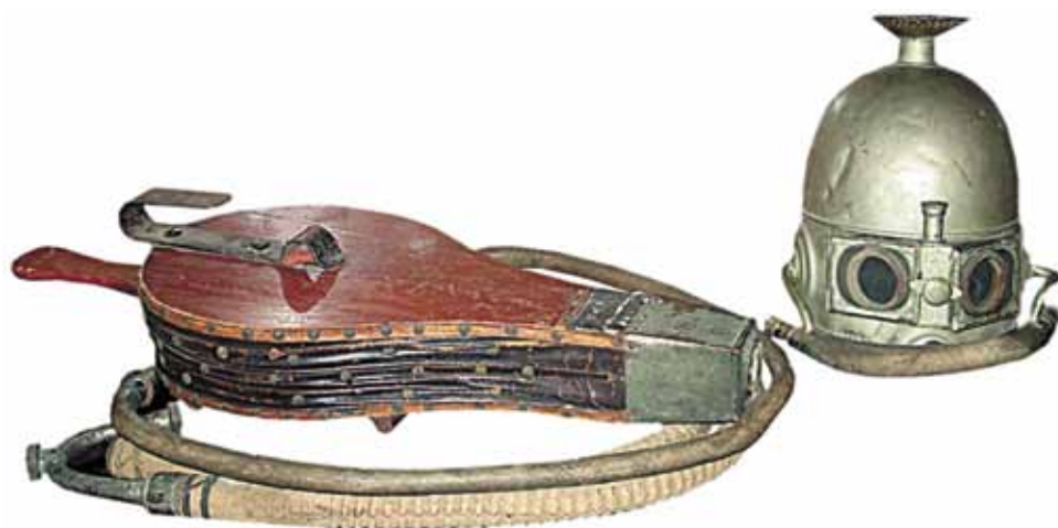
АППАРАТ КЕНИГА. Дымовая маска, позволяющая свободно работать среди удушливого дыма KENIG APPARATUS. A smoke mask which makes it possible to work free in a suffocating smoke
