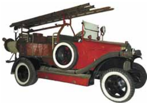
АВТОНАСОС «ПОДСТВОЛОВОЙ» Первый отечественный автомобиль серийного производства на базе грузового автомобиля марки АМО-Ф-15 московского завода АМО. 1927 г. АВТОПМР «ПОДСТВОЛОВОУ» The first series production domestic car on the base of truck (АМО-F-15 brand) of Moscow factory АМО. 1927
