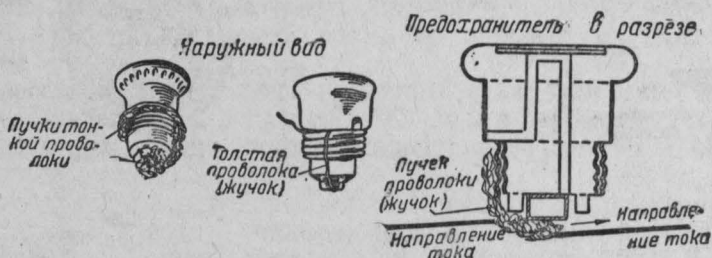
Рис. 11. Неисправный предохранитель.
