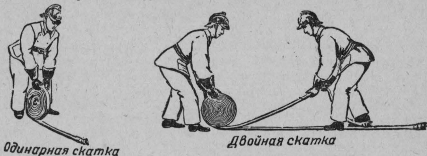
Рис. 26. Приемы скатывания рукавов
