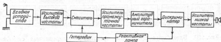
Рис. 51. Блок-схема супергетеродинного приемника с автоматической подстройкой частоты
