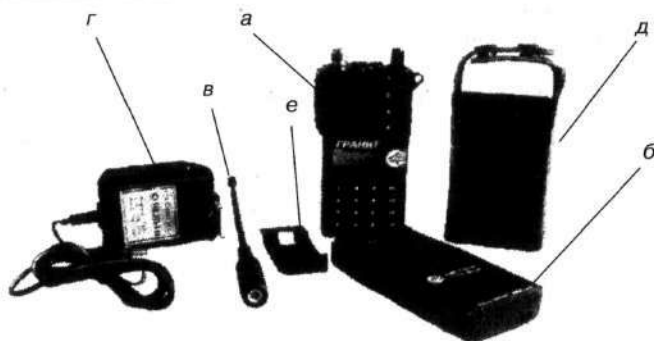
Рис. 12. Портативная радиостанция «Гранит Р33П-1»: а — радиостанция; б — аккумуляторная батарея; в — гибкая антенна; г — зарядное устройство; д — кожаный чехол; е — поясной зажим
