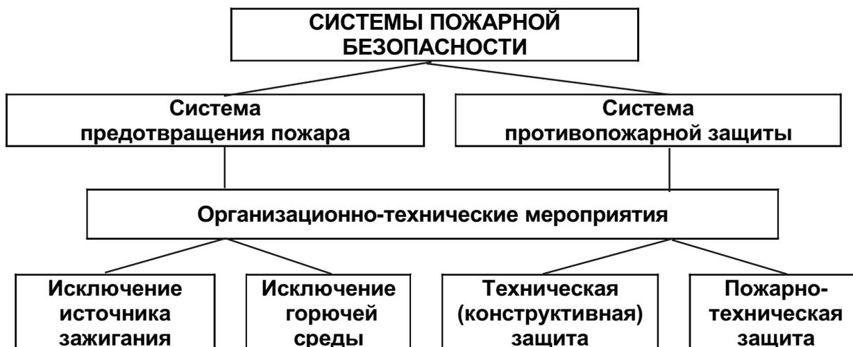
Рис. 1.2. Структурная схема систем пожарной безопасности
