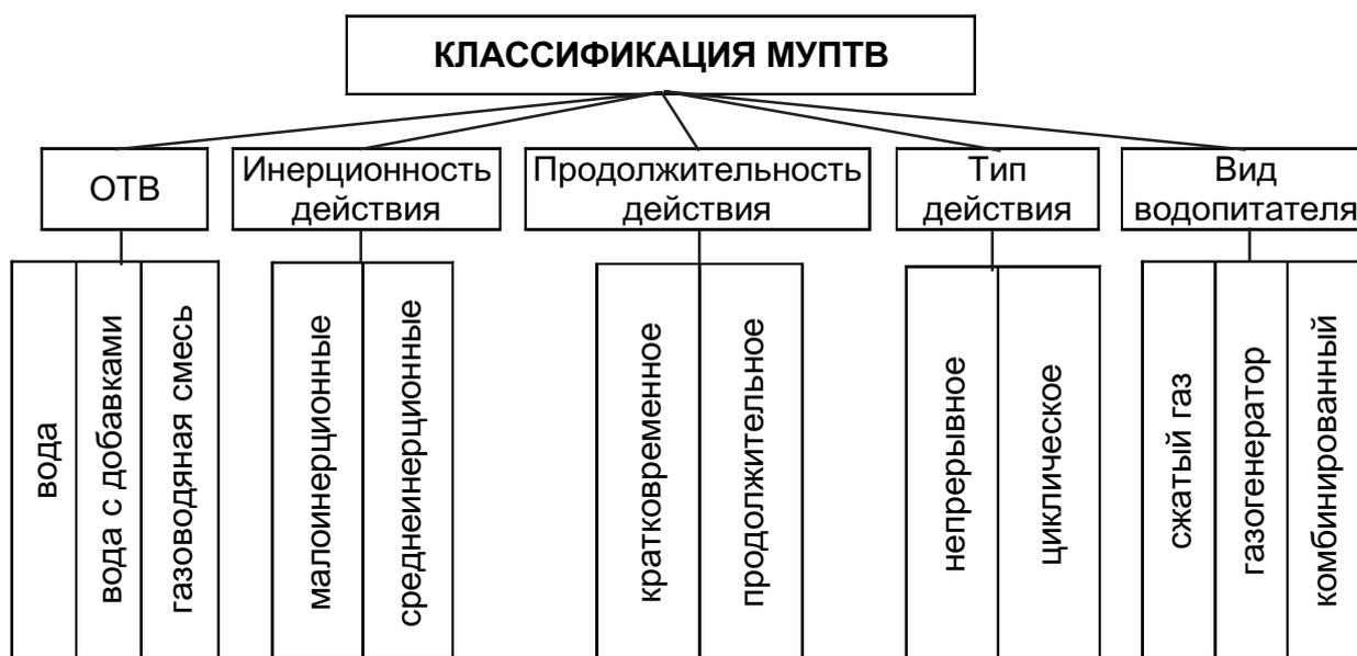
Рис. 2.9. Классификация модульных автоматических установок пожаротушения тонкораспыленной водой (МУПТВ)
