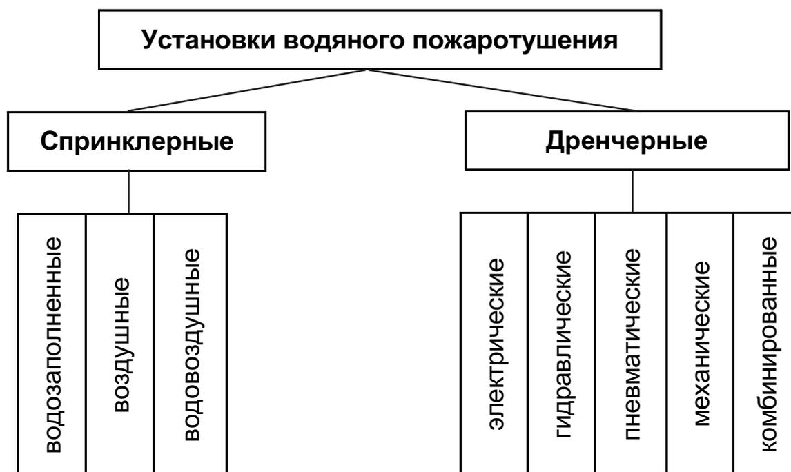
Рис. 2.8. Классификация установок водяного пожаротушения
