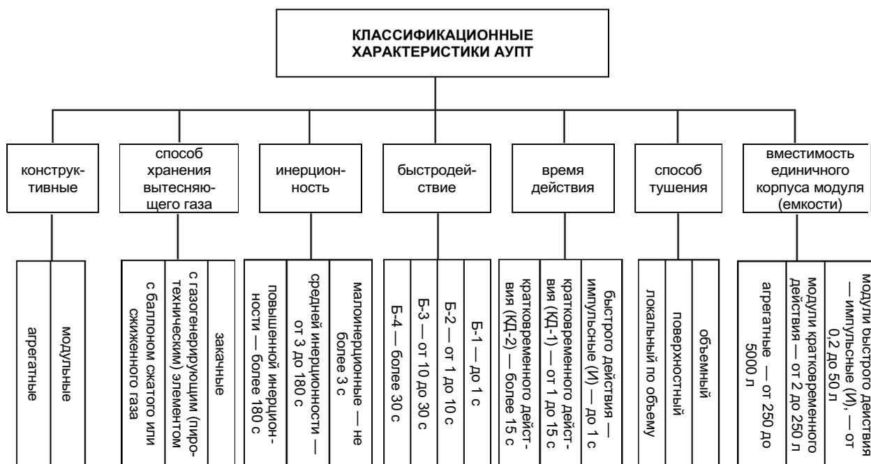
Рис. 2.10. Классификация автоматических установок
