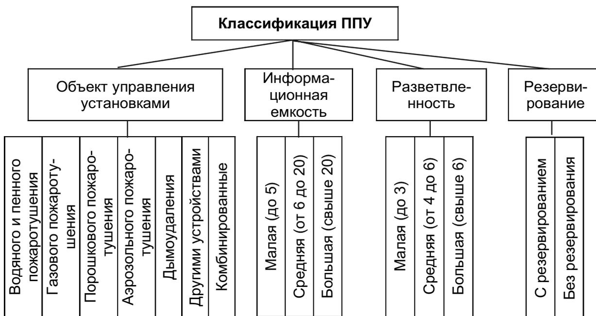
Рис. 2.4. Классификация приборов управления пожарных.
