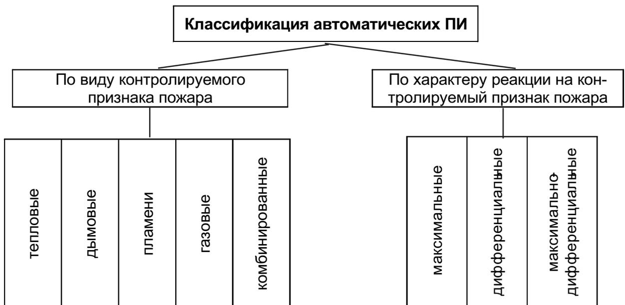
Рис. 2.6. Общая классификация автоматических пожарных извещателей.
