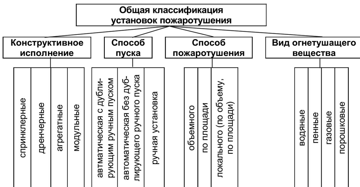
Рис. 2.7. Общая классификация установок пожаротушения
