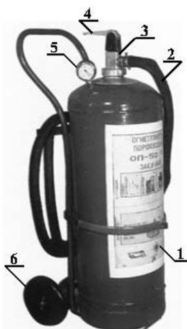
Рис. 6.4. Огнетушители порошковые ОП-50(з): корпус 1; шланг 2 с насадком; запорно-пусковое устройство с сифонной трубкой 3; рукоятка 4; ма-нометр 5; колеса 6
