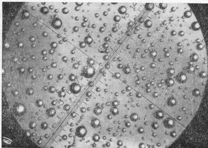
Рис. 75. Винтовой распылитель: а — общий вид; б — график расхода воды из винтового распылителя; в — микрофотография каплей из распылителя (увеличено в 50 раз).
