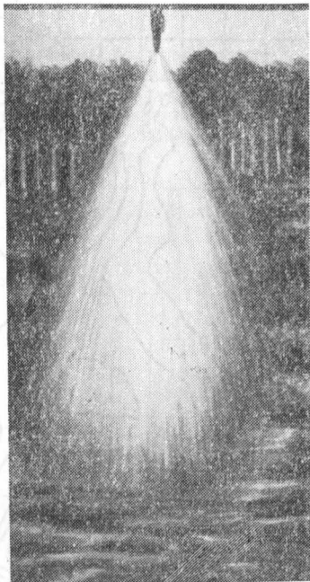
Рис. 63. Факел распыленной воды из центробежного распылителя РС.
