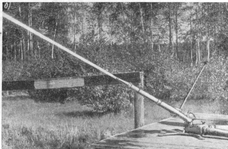
Рис. 60. Лафетный ствол ПЛСЛ-2 при подаче воды.
