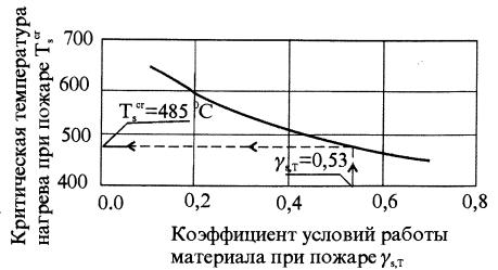
Рис.7.7.Зависимость критической температуры нагрева при пожаре T_s^{cr} стержневой арматуры Ат-V в зависимости от ее коэффициента условий работы при пожаре \gamma_{s,T}^0 (справочные данные рис.6.9)
