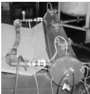
Рис. 1. Общий вид (а) и схема конструкции установки “Сержант-1” (б): 1 — устройство зажигания; 2 — фланец 1; 3 — фланец 2; 4 — рабочая полость; 5 — фланец 3; 6, 7, 8, 11, 12 — запорный кран; 9 — вентиляционный блок; 10 — циркуляционный контур; P_1, P_2 — преобразователи давления
