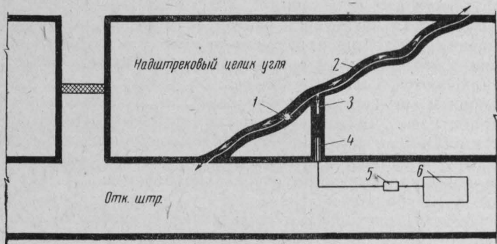
Рис. 49. Схема подачи раствора ингибитора для тушения эндогенного пожара в трещине целика угля
