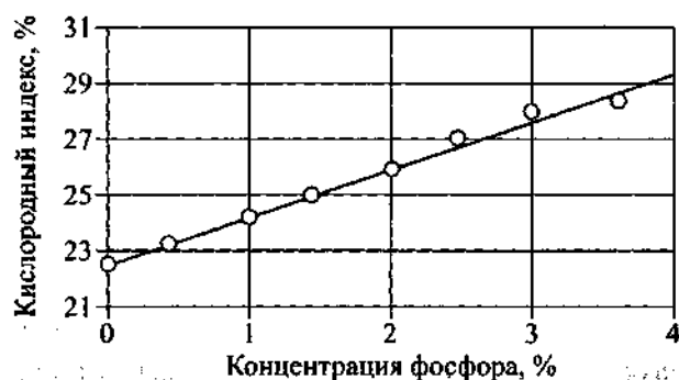
◀ Рис. 6.4. Зависимость кислородного индекса ППУ от содержания фосфора
