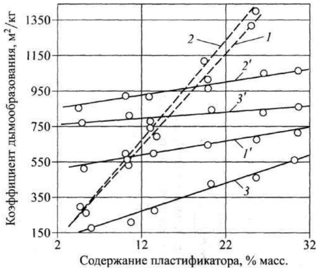
◀ Рис. 6.2. Зависимость коэффициента дымообразования пластифицированного ПВХ от содержания ДОФ (1, 1'), ТАФ-30П (2, 2') и ТХПФ (3, 3') в режимах тления (1–3) и горения (1'–3')
