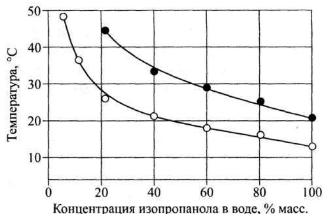
◀ Рис. 5.7. Температуры вспышки (○) и воспламенения (●) водных растворов изопропанола
