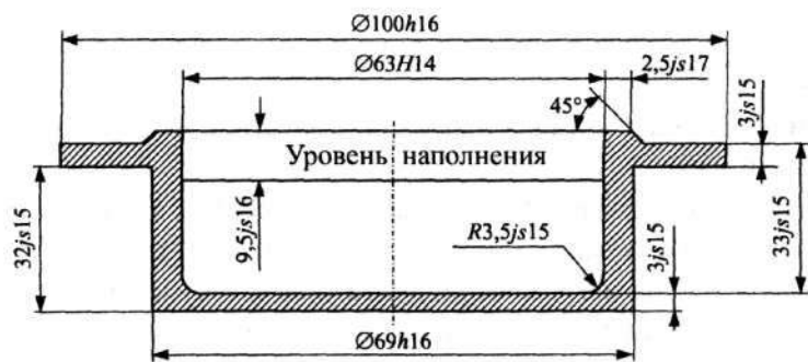
◀ Рис. 4.25. Тигель для измерения температуры вспышки
