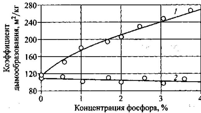
◀ Рис. 6.5. Дымообразующая способность фосфорсодержащих ППУ в режиме: 1 — пламенного горения; 2 — тления
