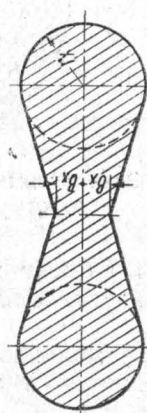
Рис. 2. Зона защиты двойного стержневого молниеотвода высотой h \leq 30 м. Зона защиты на уровне h_x
