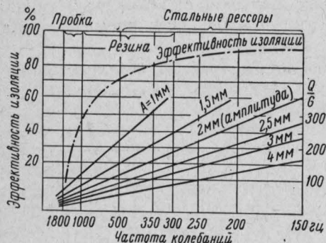
Рис. 10.11. Зависимость между собственной частотой и эффективностью изоляции при упругом монтаже
