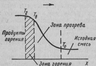
Рис. 12.1. Распределение температур в горящей газовой смеси
