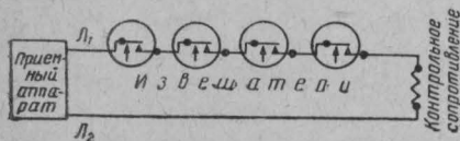
Рис. 2. Схема включения извещателей при работе на размыкание
