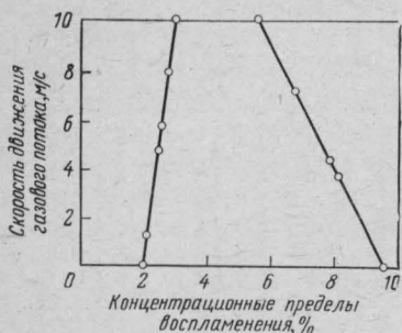
Рис. 27. Зависимость концентрационных пределов воспламенения от скорости движения газового потока (давление газа 0,1 МПа).
