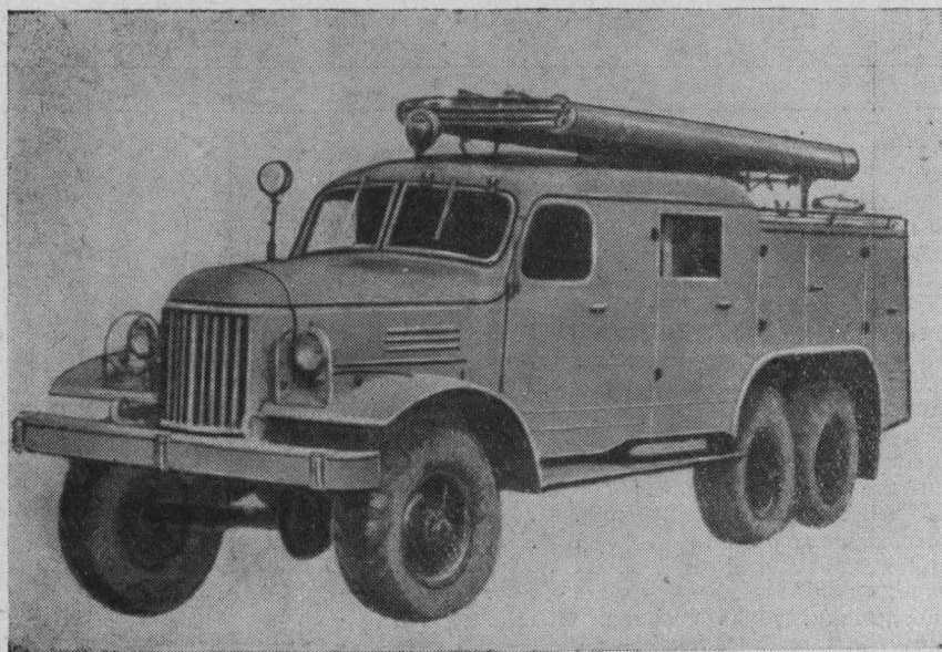
Рис. 32. Общий вид аэродромного автомобиля АА-25 (157)
