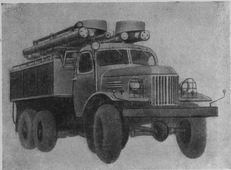
Рис. 41. Автомобиль химического пенного тушения АХ-2,4 (157К)
