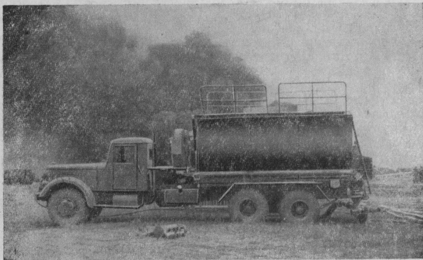
Рис. 44. Автомобиль химического пенного тушения АХ-9 (219)
