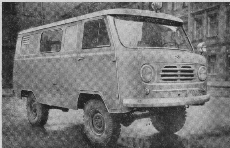
Рис. 28. Внешний вид штабного автомобиля-лаборатории АШЛ-4 (452А)
