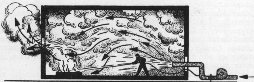
Рис. 6. Схема работы дымососа на нагнетание свежего воздуха в помещение
