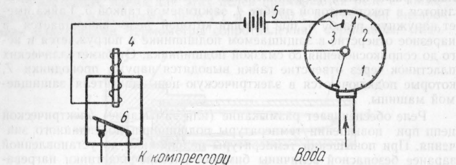
Рис. 36. Схема защиты компрессоров
