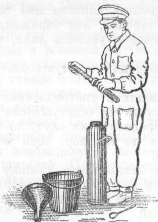
Рис. 6. Установка в металлическую корзинку колбы с кислотой.
