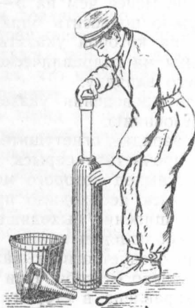
Рис. 7. Установка корзинки с колбами в огнетушитель.
