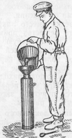
Рис. 5. Заполнение корпуса огнетушителя раствором.
