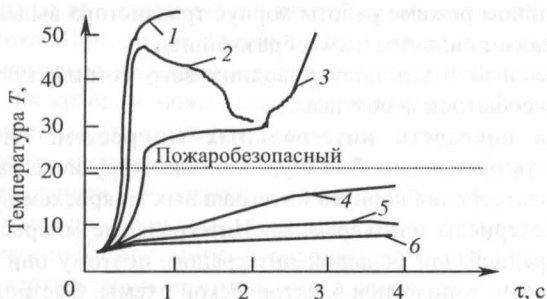
Рис. 1.10. Зависимость температуры корпуса интегральной микросхемы от времени в аварийном режиме
