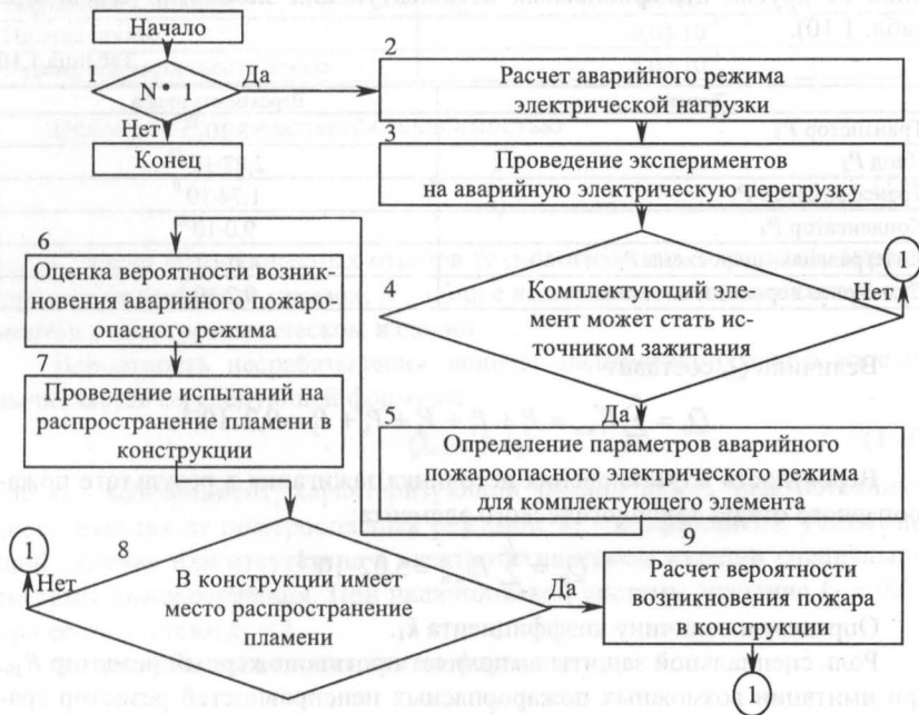
Рис. 1.6. Алгоритм определения пожарной опасности электротехнических изделий (электроустановок): N – число комплектующих элементов в электротехническом изделии электротехнических устройств
