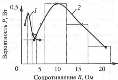
Рис. 1.14. Вероятность возникновения отказа типа «КЗ» (короткое замыкание) конденсаторов типа К53-19-6,3В-330 пФ (1), К73-17-250В-0,66 мкФ (2)
