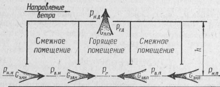
Рис. 18.1. Расчетная схема газообмена
