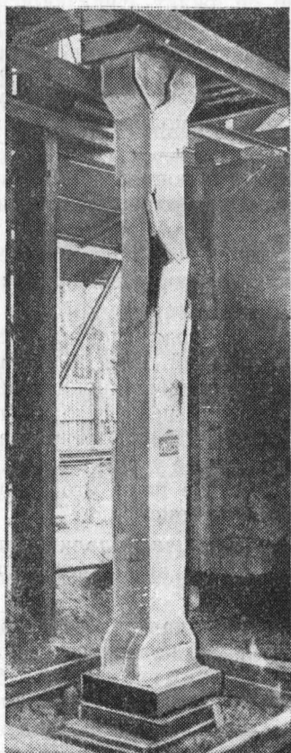
Рис. 5. Характер разрушения штукатурки стальной колонны после 45 мин. испытания на огнестойкость.
