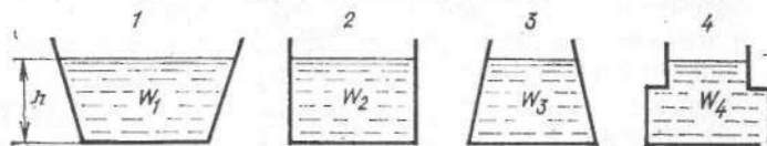
Рис. 8. Схема, поясняющая явление гидростатического парадокса 1, 2, 3, 4 — варианты различной формы сосудов
