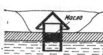
Рис. 126. Утепление проруби при вмораживании трубы
