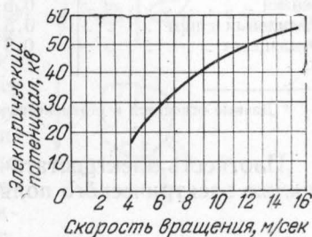
Рис. 10. Изменение электрического потенциала кожаного плоского ремня в зависимости от скорости его вращения.
