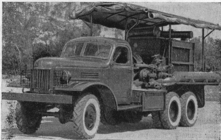
Рис. 72. Передвижная насосная станция производительностью 500 м 3 /ч.
