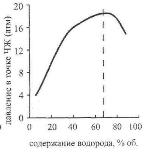
Рис. 4.10. Зависимость давления в точке ЧЖ от содержания водорода в кислородоводородной смеси
