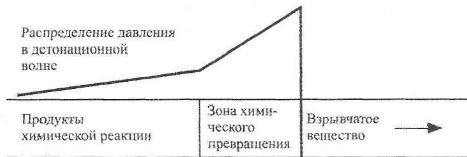
Рис. 4.3. Схема детонационной волны
