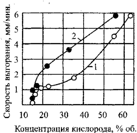
Рис. 4.29. Зависимость скорости выгорания дизельного топлива (1) и бензина (2) от концентрации кислорода в газовой среде
