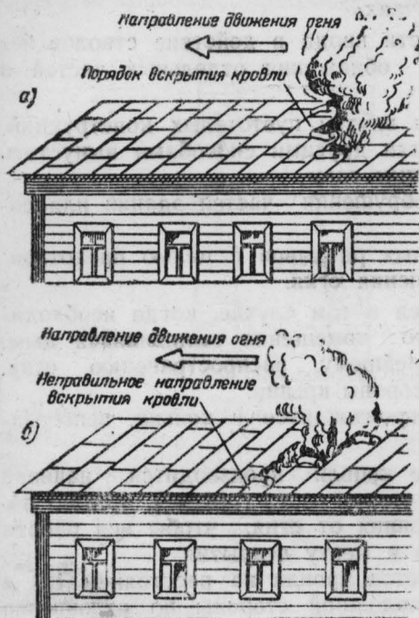
Фиг. 55. Порядок вскрытия кровли (1, 2, 3): а — правильно; б — неправильно.
