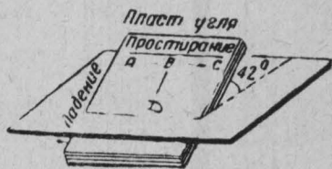
Фиг. 1. Элементы залегания пласта угля.
