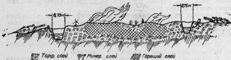
Фиг. 154. Ограничение распространения торфяного пожара канавами, наполненными водой.
