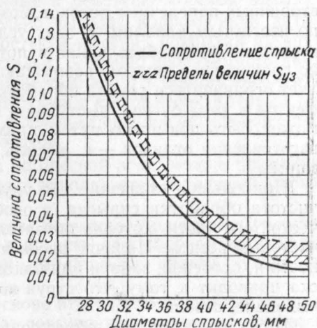
Рис. 11. Сопротивление лафетного ствола (ствол, sprysk и фасонные части).
