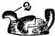
Рис. 18. Гайка Рота. 1—гайка в сомкнутом виде; 2—цепные ушки гайки.
