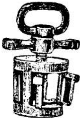
Рис. 8. Конус с 4 шарнирными клапанами. Наружный вид.
