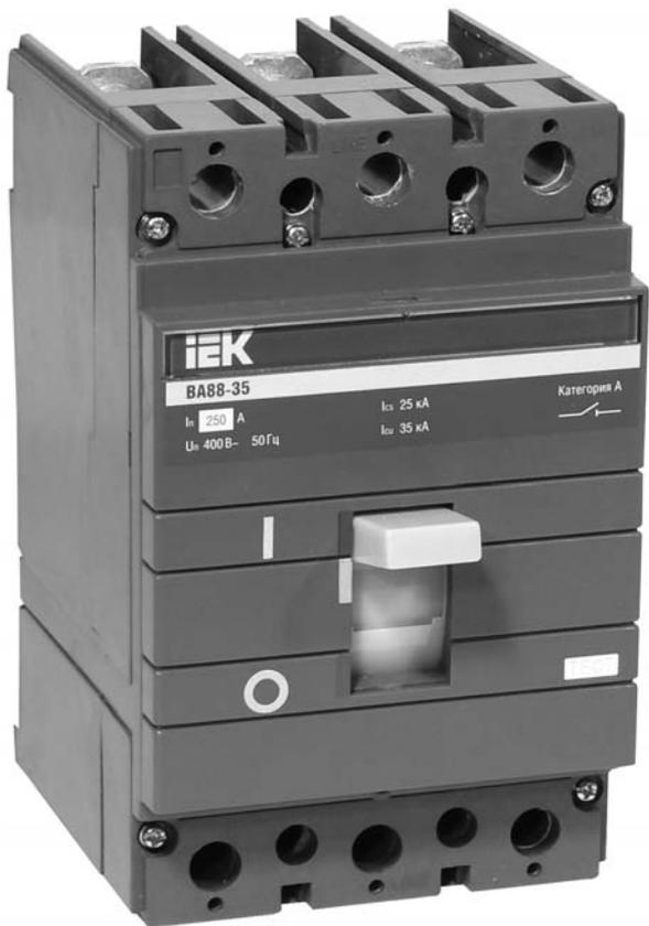
Автоматические выключатели серии BA88 предназначены для проведения тока в нормальном режиме и отключения тока при коротких замыканиях, перегрузках, недопустимых снижениях напряжения в трехфазных электрических сетях переменного тока напряжением до 400 В частотой 50 Гц.
