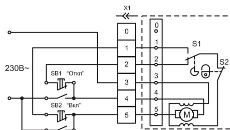
M – электродвигатель; S2 – контакт, управляемый замком;
