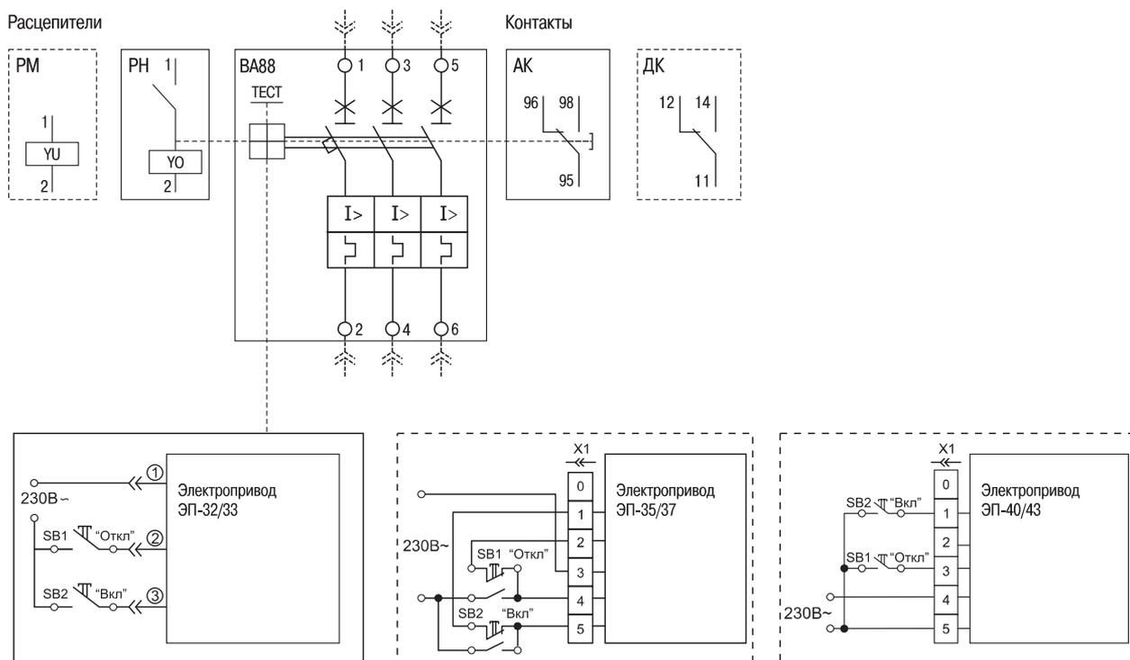
Автоматический выключатель ВА88 с электронным расцепителем и дополнительными устройствами
