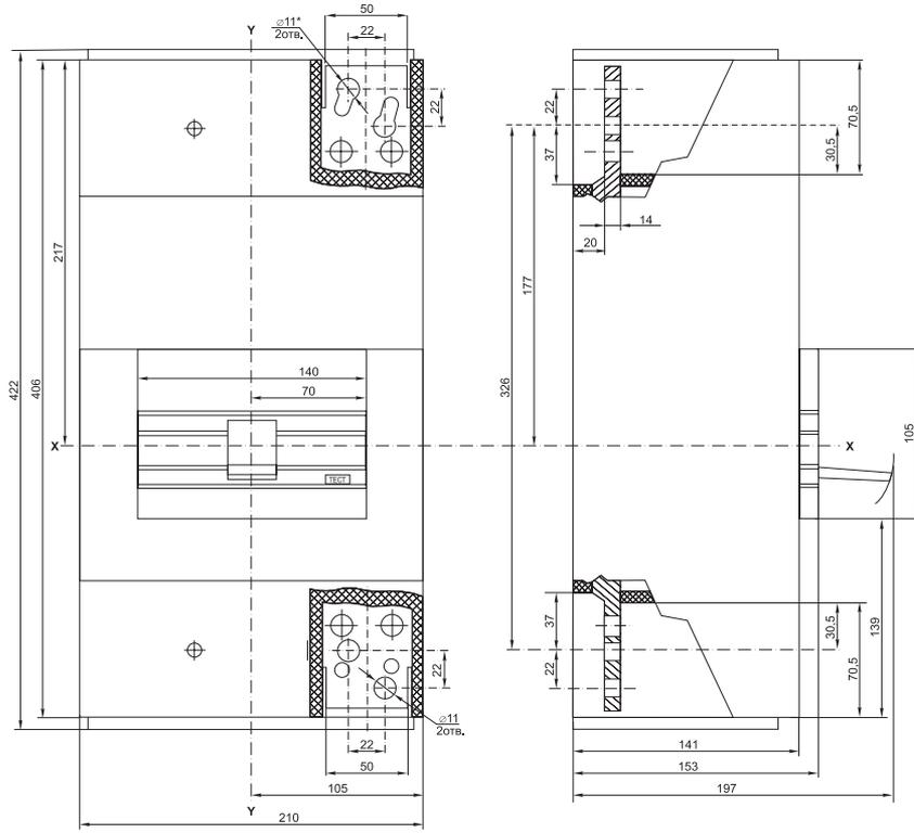
\*Отверстия предназначены для крепления наконечника-переходника
