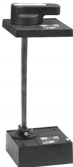
Привод закрепляется на двери распределительного устройства для оперирования выключателем через дверь. Он снабжен устройством для навесного замка блокировки в отключенном состоянии. Может быть установлено до 3-х замков с диаметром дужки 6 мм (в комплект не входят).
