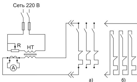
Рисунок 1. Принципиальная схема испытания расцепителей автоматических выключателей:
