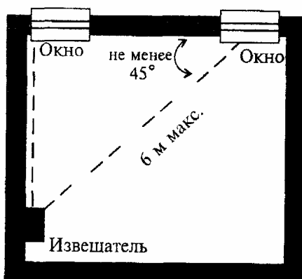
Рисунок 6.4 - Варианты установки извещателя охранного поверхностного "Стекло-1"
