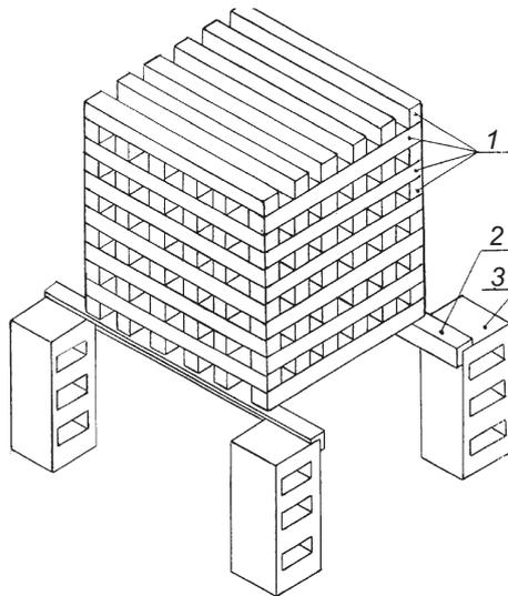
1 — деревянные бруска; 2 — стальной уголок; 3 — бетонный (металлический) блок
