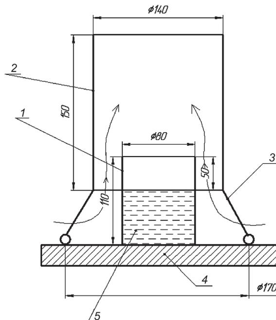
1 — горелка; 2 — защитный кожух; 3 — соединительные стержни; 4 — полка; 5 — горючая жидкость (стрелками показано направление движения воздуха)
