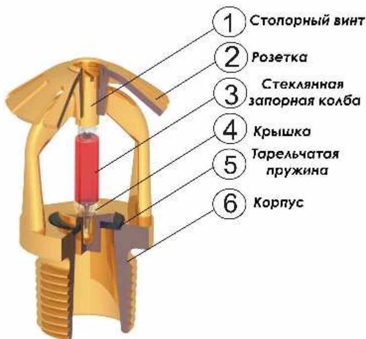
Рисунок 1. Конструкция спринклерного оросителя.
