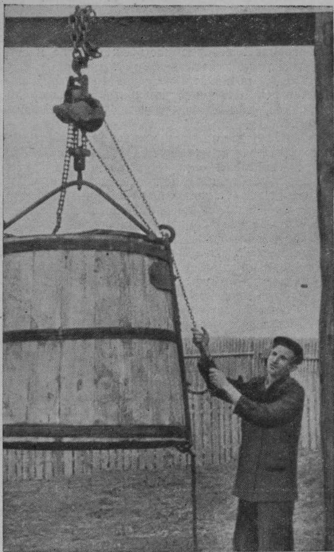
Стоит потянуть за цепь Галля — и подвесной чан окажется на дне кузова автомашины.
