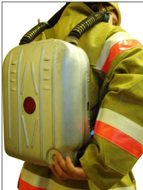
Рис. 7.8. Проверка работы аварийной подачи.
