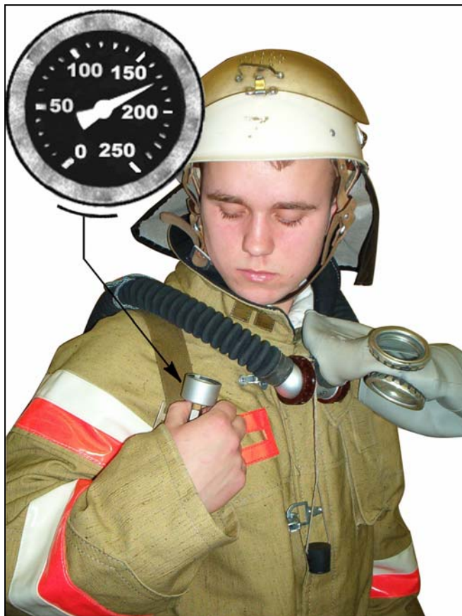
Рис. 7.9. Проверка давления.
