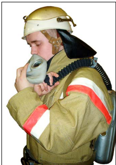
Рис. 7.3. Проверка герметичности клапана вдоха.
