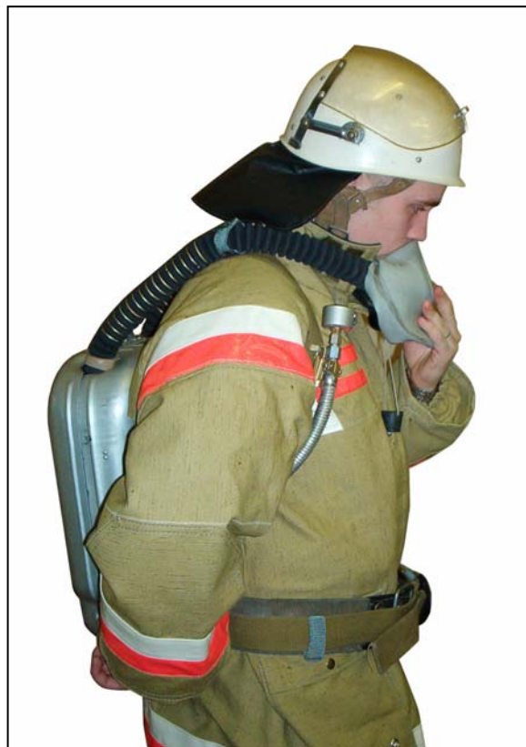
Рис. 7.7. Проверка работы легочного автомата.
