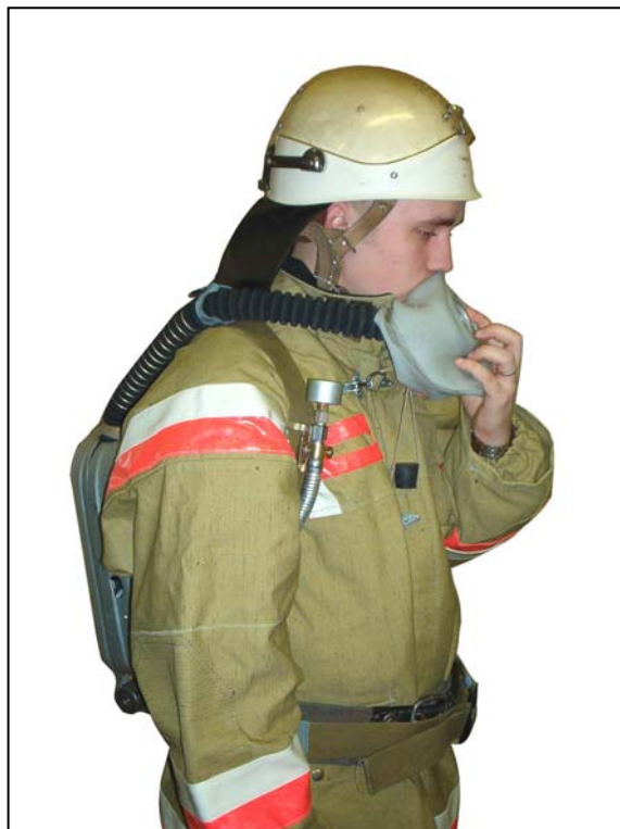
Рис. 7.5. Проверка герметичности на разрежение.
