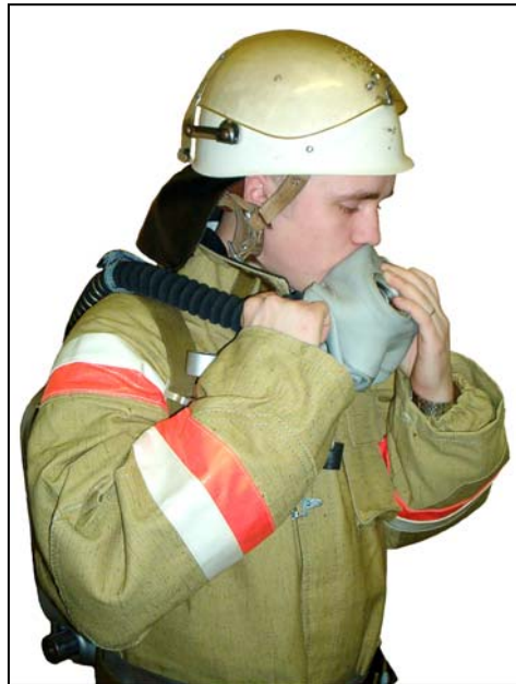
Рис. 7.4. Проверка герметичности клапана выдоха.
