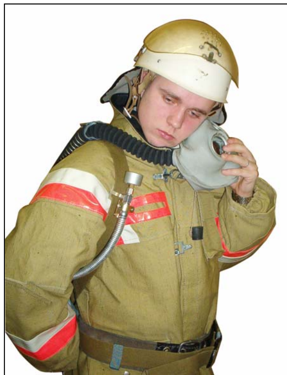
Рис. 7.6. Проверка работы постоянной подачи.
