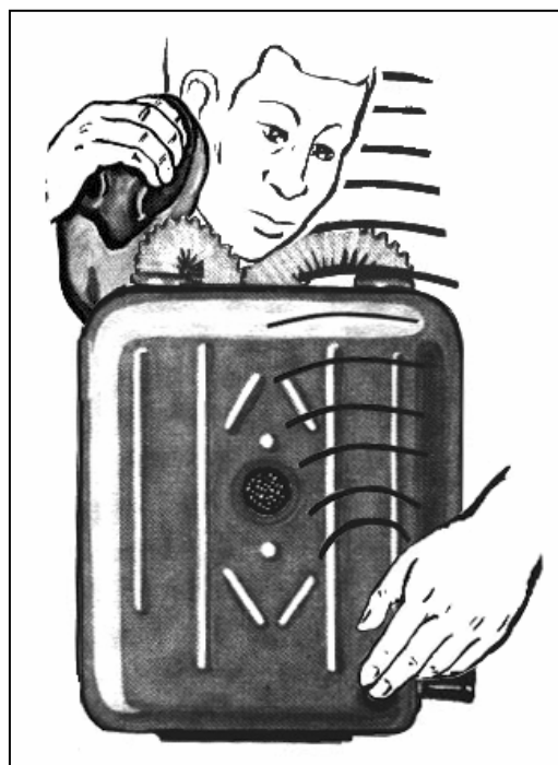
Рис. 8.8. Проверка работы аварийной подачи.
