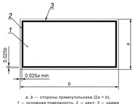
Рисунок 7 — Основа цветографического изображения и соотношение размеров дополнительных знаков безопасности
