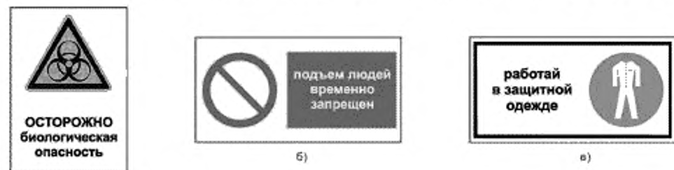
а) — текст расположен ниже знака безопасности; б) — текст расположен справа от знака безопасности, в) — текст расположен слева от знака безопасности
